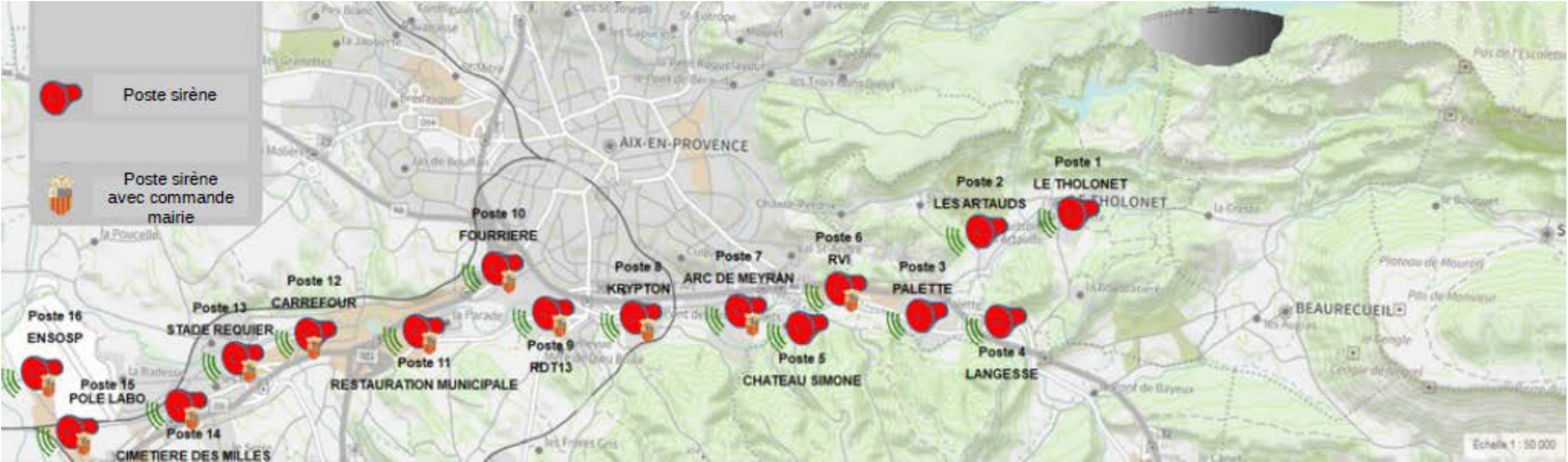
Les sirènes d’alerte « corne de brume » du barrage de Bimont sont implantés dans la zone de proximité immédiate
